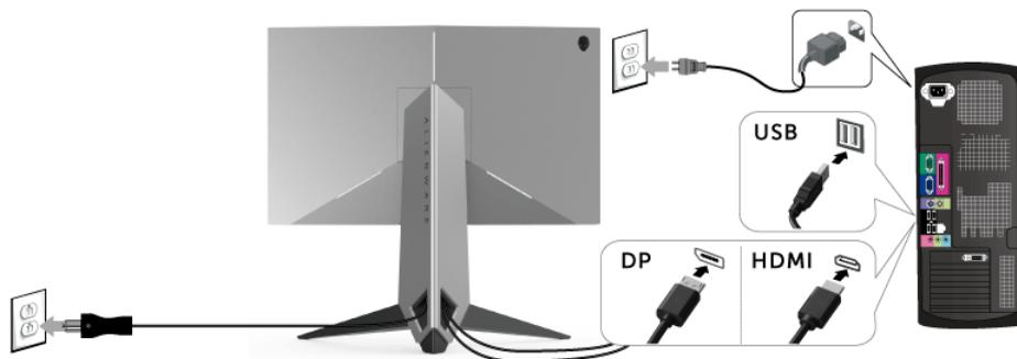
1. Conecte a outra extremidade do cabo DP ou HDMI conectado ao seu computador.
