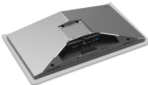
2. Fixe o suporte elevatório até que ele se encaixe no local adequado.
