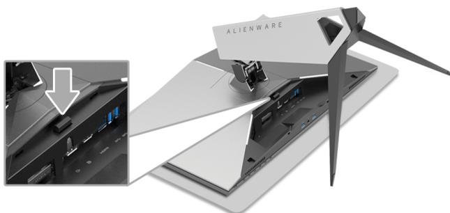
7. Levante o suporte elevatório afastando-o do monitor.
